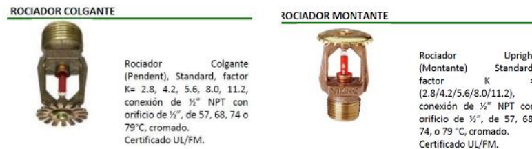
Figura 14: Rociador colgante y de montaje
