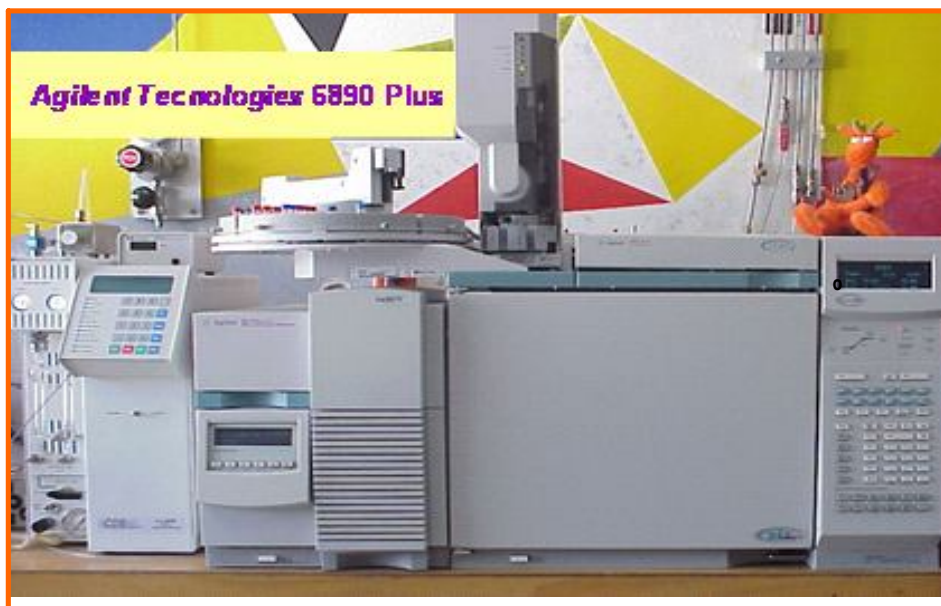
Figura 7: Cromatógrafo de gases de alta resolución Agilent Technologies 6890 Plus , con detector selectivo de masas Agilent Technologies MSD 5973
