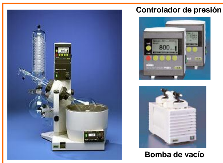
Figura 6: Equipo de destilación al vacío.
