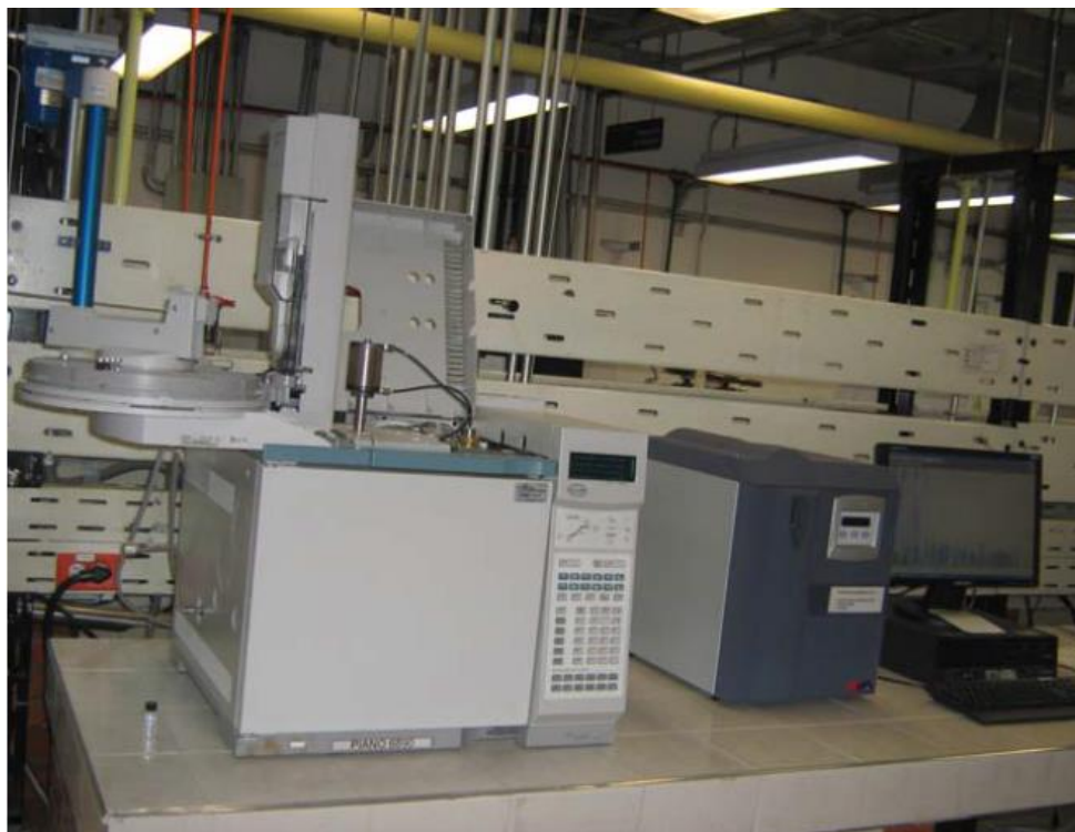
Figura 6. Cromatógrafo de gases 6890N Agilent Technologies con detector de ionización en llama (FID). Laboratorio de cromatografía ICP.
