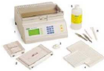
Fig. 10: Equipo de Isoelectroenfoque: protean IEF cell, bio-rad
