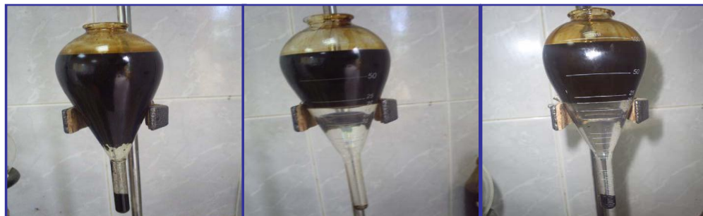
Figura 9. Análisis de contenido de hidrocarburo en emulsiones, muestras tomadas en API de planta deshidratadora (en su orden: drenaje de tratadores térmicos, drenaje de tanques y punto de mezcla API)
