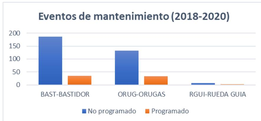
Para el caso de los bastidores, se realiza monitoreo del porcentaje desgaste de los 8 rodillos inferiores y de las ruedas guía delantera y trasera. En la oruga se mide el desgaste de los bujes, eslabón, paso o estiramiento y zapata (Anexo A). El porcentaje de desgaste se define de acuerdo con las tablas provistas por el fabricante del componente (Anexo B). Estas mediciones son realizadas cada 1000 horas de operación, que por lo general se ejecutan en dos meses. El sistema genera
