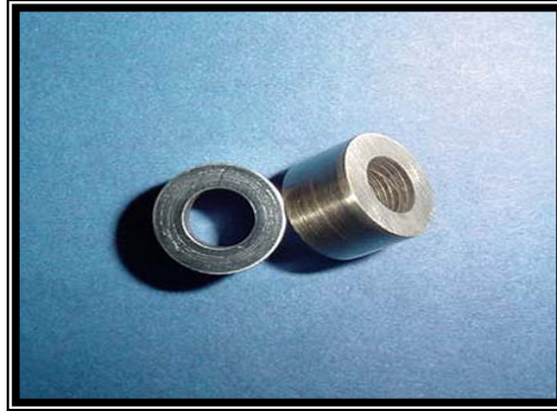
Figura 11 Electrodo de trabajo utilizados en los ensayos en el ECR.
