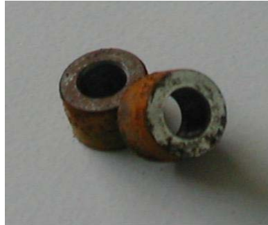
Figura 14 Formación de capas superficiales de productos de corrosión sobre el electrodo de acero al carbono en una solución de NaCl al 3%.
