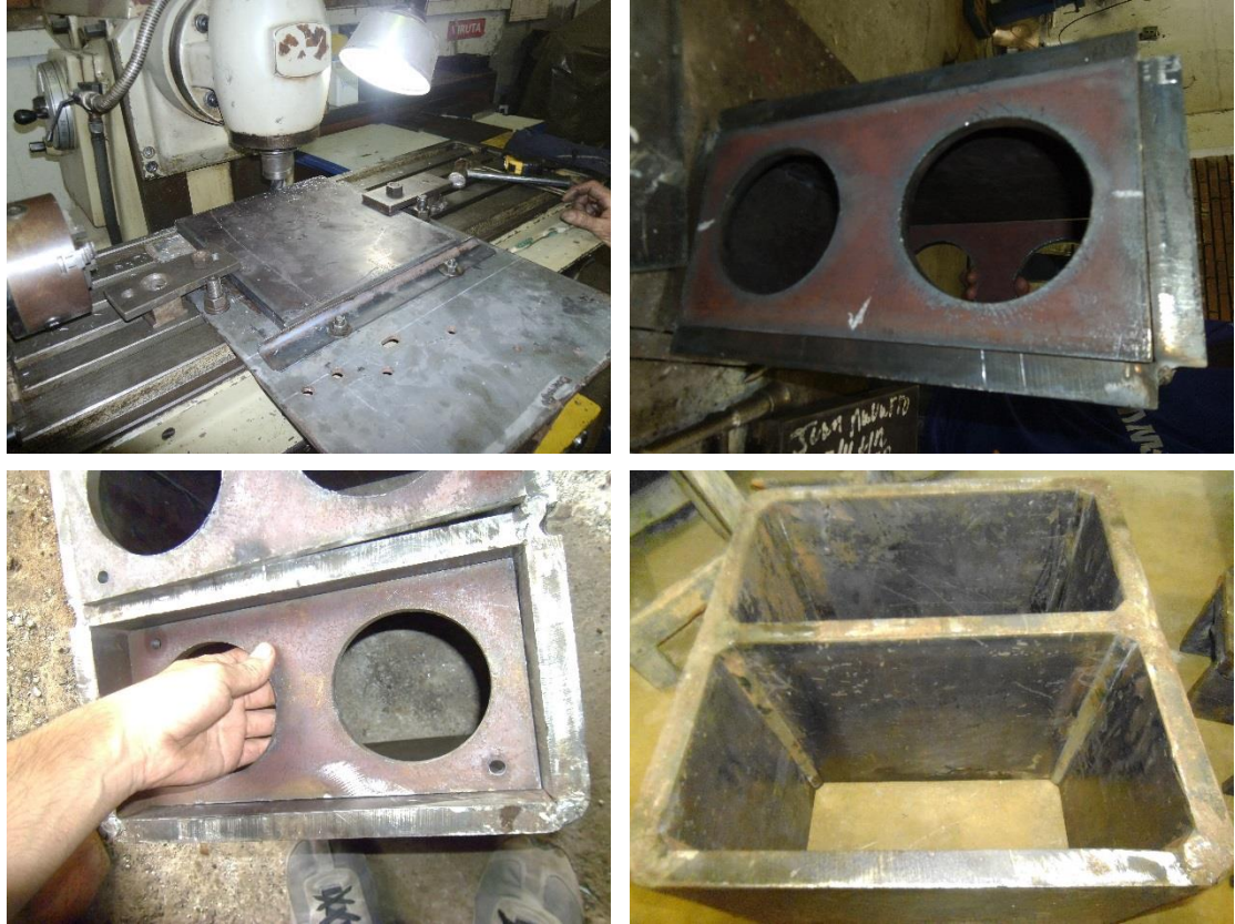
Figura 62. Construcción de la cámara de prensado
