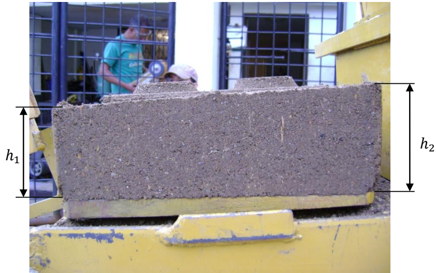
Figura 4. Falla en el ladrillo por desbalance del mecanismo.
