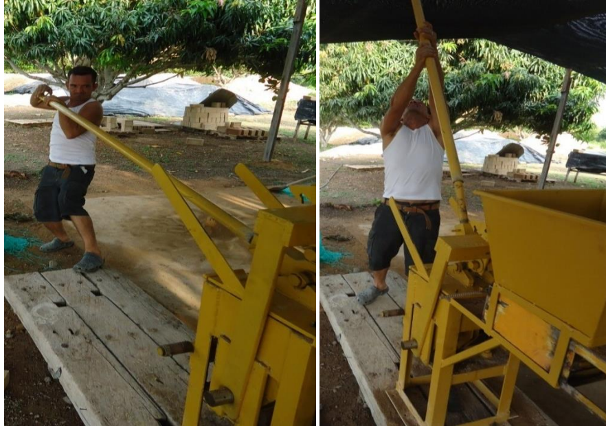
Figura 8. Proceso de prensado en una CINVA-RAM
