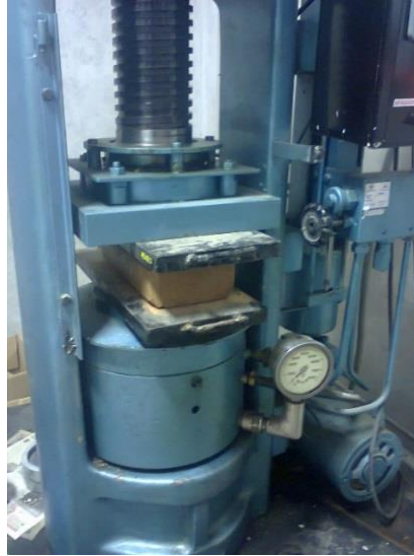
Figura 76. Ensayo de compresión
