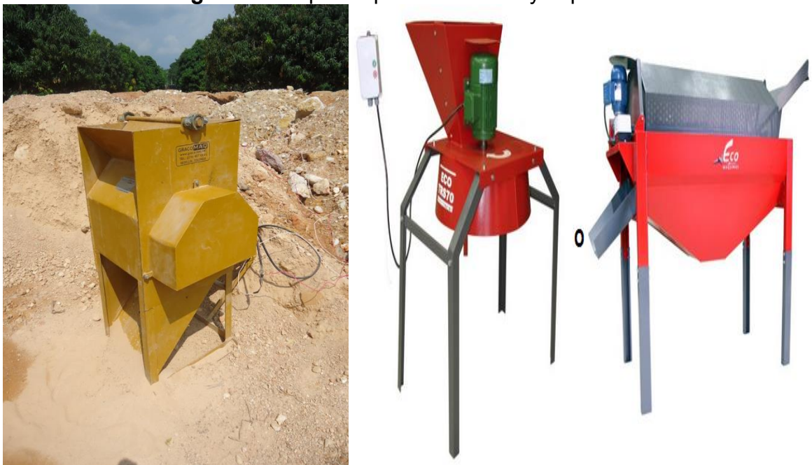
Figura 6. Máquinas para trituración y separación
