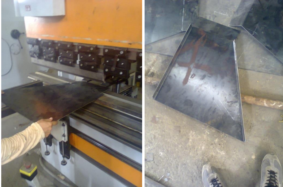
Figura 72. Construcción de la tolva
