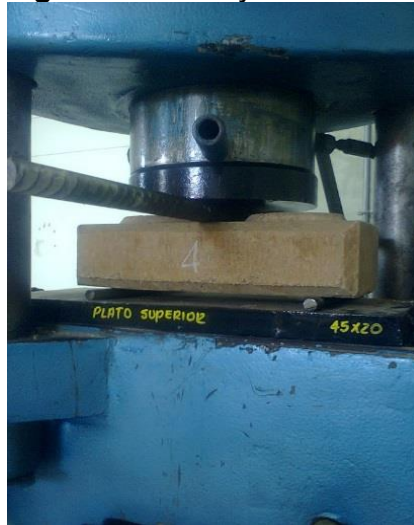
Figura 77. Ensayo de flexión.
