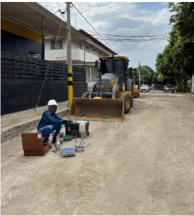
Figura 21. Método del cono y arena.
