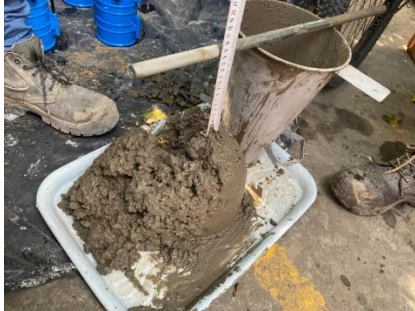
Figura 23. Ensayo de asentamientos en sitio.
