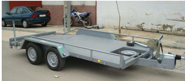
Figura 26. Chasis con ruedas externas
