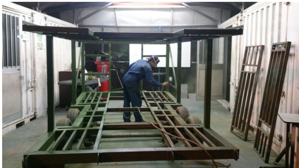
Figura 73. Pintado con anticorrosivo
