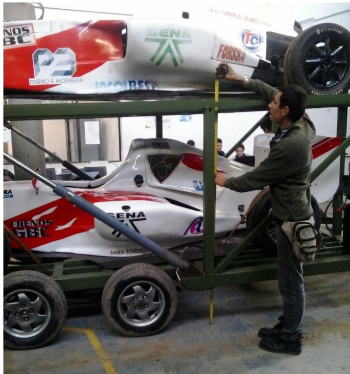
Figura 80. Aprendiz CIMI midiendo deformaciones del remolque
