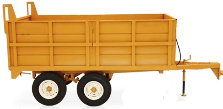
Figura 2. Remolque no balanceado
