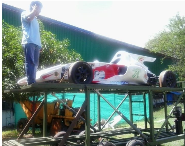
Figura 85. Carga en posición horizontal sin aseguramientos
