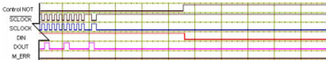
Figura 37. Señales enviadas por el Transceiver al microcontrolador, fin del envío
