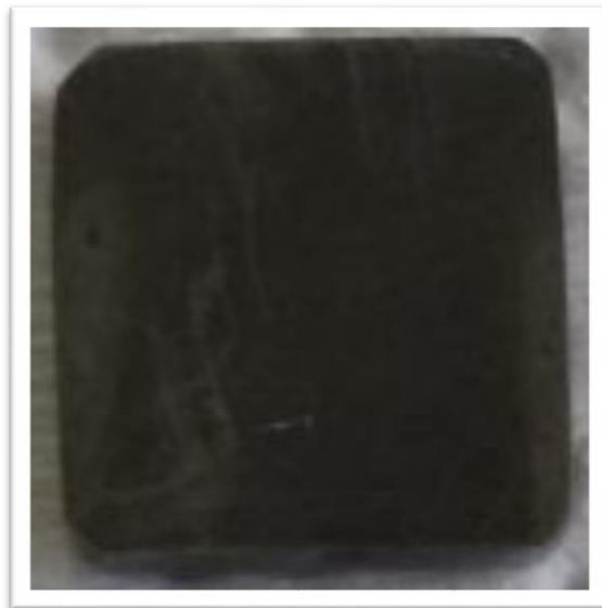
Figura 13. Acero AISI-316 con productos de corrosión.
