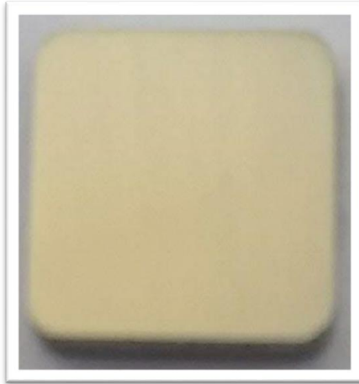
Figura 12. Acero AISI-316 preparado metalográficamente.
