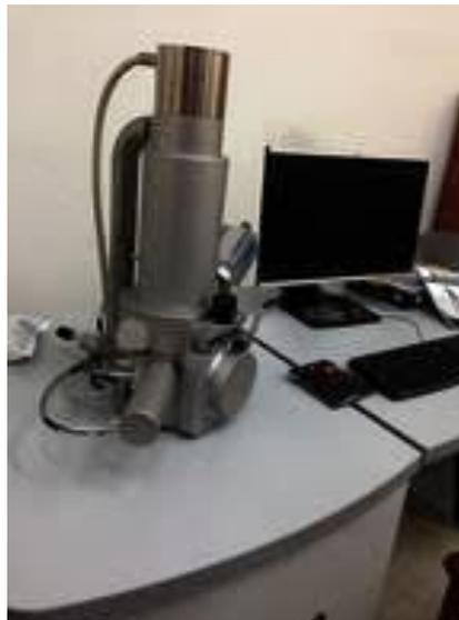
*Fuente: Fotografía tomada de laboratorio de integridad UNAL. Microscopio Tescan Vega 3 SB.*
