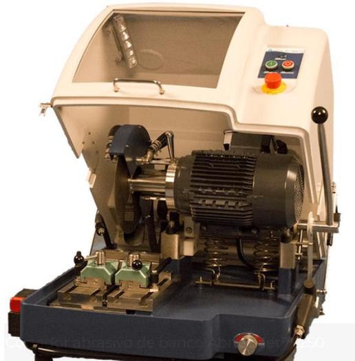
*Fuente: Fotografía tomada del manual del fabricante Buehler. Banco de Corte Abrasimet 250.*
