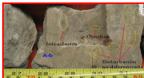
Figura 344. Núcleos de la sección vertical escogida. Facies A-b, ambiente de Llanura de Inundación. Se resaltan algunas características de dicha facies como intraclastos, conchas y bioturbación.
