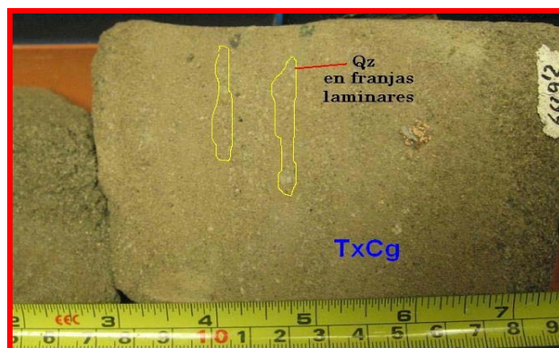
Figura 53. Núcleos de la sección vertical escogida. Facies TxCg, ambiente de Canal, en la imagen se resaltan fragmentos de cuarzo distribuido en franjas.
