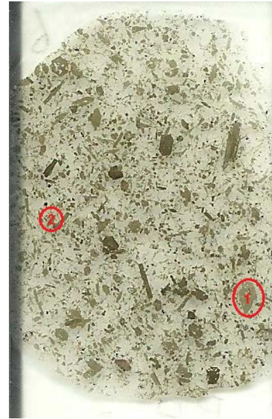
Figura 15. Muestra Pp20 (Tonalita) macroscópica y microscópicamente de la cantera Cerro Papayo.
