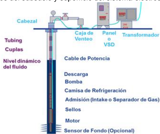
Figura 3. Equipos del subsuelo y superficie del sistema electrosumergible.
