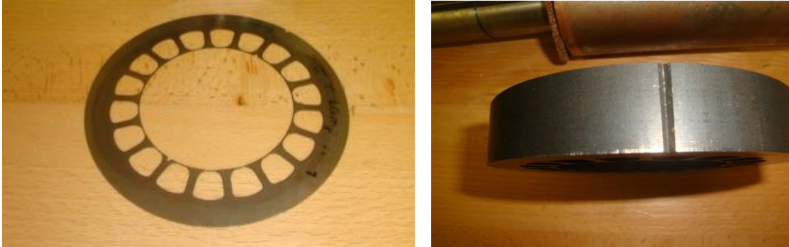
Figura 8. Lámina de acero - conjunto de láminas prensadas
