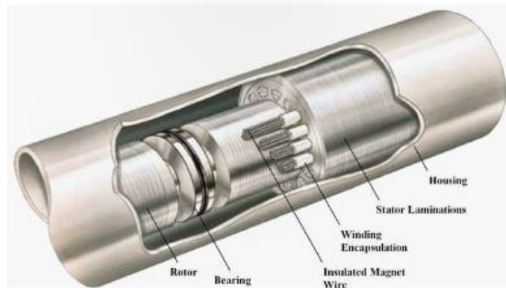
Figura 6. Diseño interno del motor ESP
