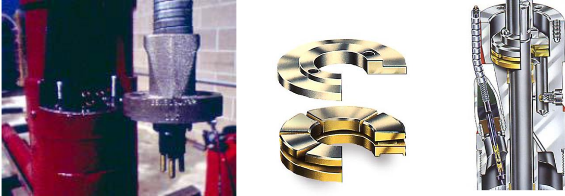
Figura 10. Empalme motor- cable de potencia-rodamientos de empuje
