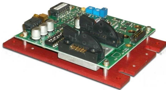
Figura 23. Tarjeta controladora de laser C150 la cual contiene un driver de control de temperatura TEC ideal para evitar calentamientos bruscos en el diodo laser es compatible con el diodo laser EP 2004-DM-B. Adaptado de hoja de datos controlador C150.
