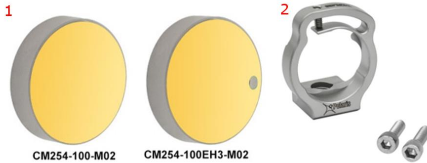
Figura 47. Espejos y soportes. Espejos cóncavos de 1” (25.4 mm) de diámetro referencias CM254-100EH3-M02 y CM254-100-M02 de ThorLabs con y sin orificio respectivamente, los cuales tienen un recubrimiento de oro altamente reflectivo que los hace más resistentes a la humedad y otros efectos ambientales. 2) Soporte tipo tornillo modelo POLARIS-B1S de la marca Polaris el cual está diseñado para las dimensiones de estos espejos.
