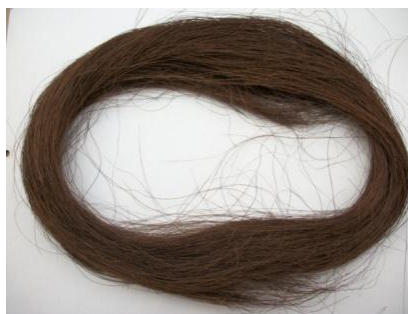
Figura 1. Fibras de fique sintetizadas con nanopartículas de MnO 2
