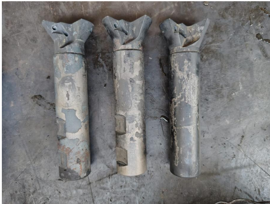
Figura 39. Estado de las herramientas posterior al enfriamiento en agua
