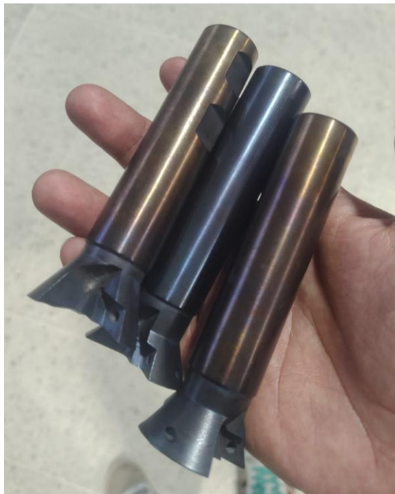
Figura 40. Estado final cola de milano finalizado el tratamiento térmico
