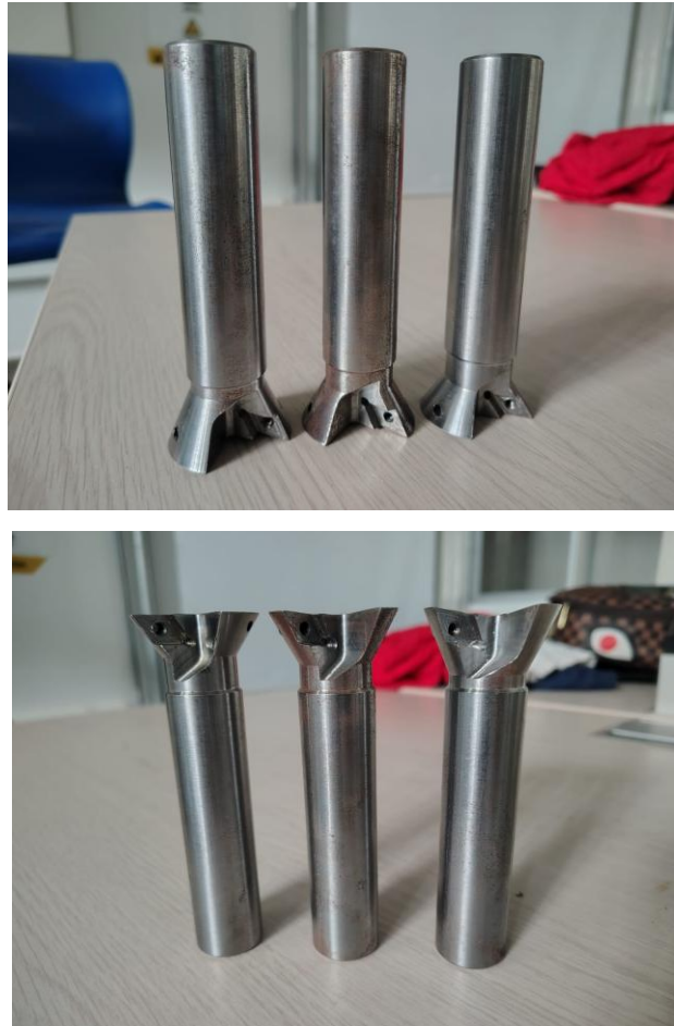
Figura 34. Forma final herramienta cola de milano
