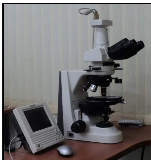
Figura 2. Microscopio óptico de luz transmitida NIKON ECLIPSE E200 50/POL con cámara y pantalla incorporada Digital S DS-L1. Escuela de Geología, (UIS).
