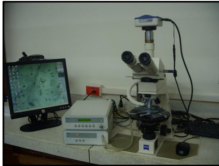
Figura 4. Microscopio de Luz transmitida marca NIKON ELIPSE 50i, con platina de enfriamiento y calentamiento THMS 600 marca LINKAM. Laboratorio de Geología, sede Guatiguará (UIS).
