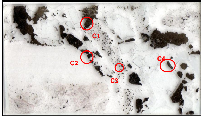
Figura 44. Distribución espacial de los cristales de pirita seleccionados para el análisis de química mineral. Sección delgada muestra MBM-LB140-08A.
