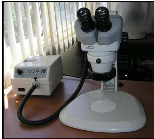
Figura 1. Lupa bipolar NIKON N1-150 MODELO C-PS para la descripción macroscópica de muestras. Laboratorio de lupas, Escuela de Geología, (UIS).
