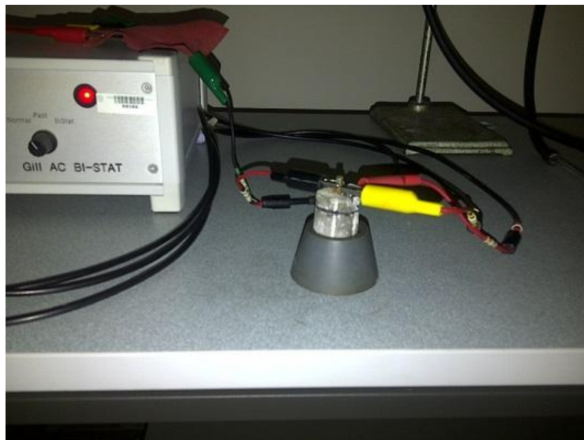
Figura 27. Montaje utilizado para la técnica de espectroscopia de impedancia electroquímica. Grupo de Investigación a la Corrosión GIC, UIS.
