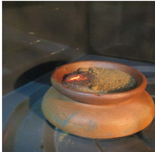
Figura 12. Sinterización y tostación parcial de la muestra
