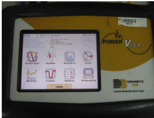
Figura 23. Analizador de calidad de potencia PowerVisa
