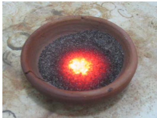
Figura 16. Mineral “Juan Blanco” malla 50 sinterizado por sobrecalentamiento
