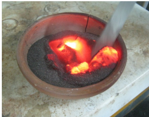
Figura 17. Mezcla manual del mineral Juan Blanco malla 50, para mantener homogénea la temperatura en la muestra
