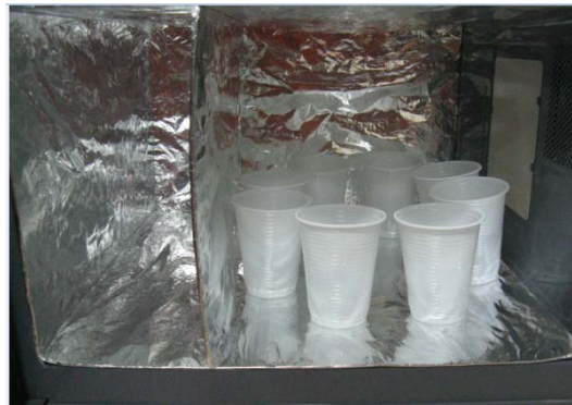
Figura 40. Disposición de la prueba para la cavidad reducida 12 cm de ancho
