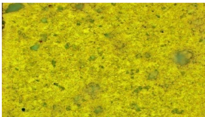
Figura E1. Imágenes microscopio interferométrico Cristal con recubrimiento PLGA 70/30 HAP 10% Q 3%
