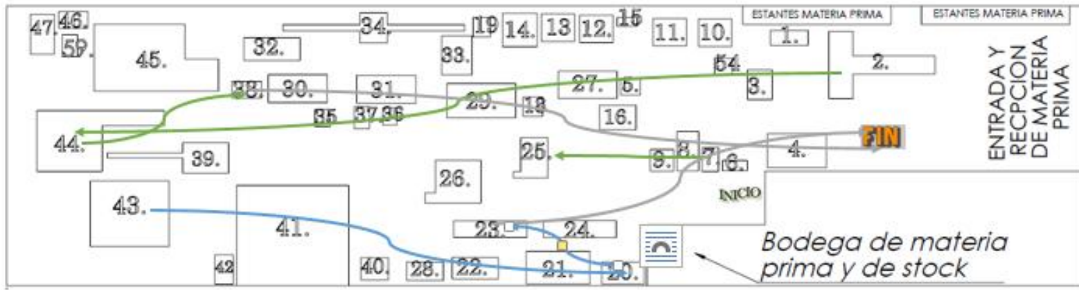
Figura 74. Movimientos para CERRADURA CENTRAL TAMBOR
