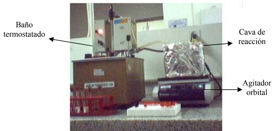
Figura 12. Montaje empleado para efectuar la reacción de alcoholólisis
