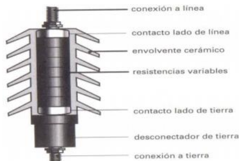
Figura 18. Partes principales del pararrayos de óxido de zinc (ZnO). Tomado de [12].
