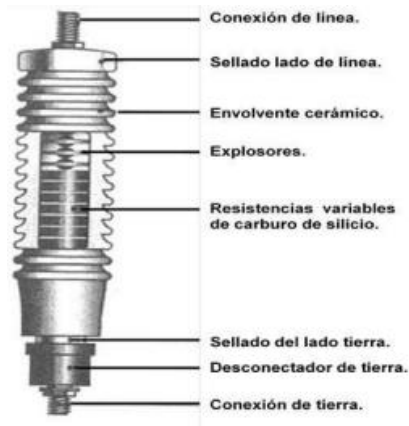
Figura 16. Esquema básico de un DPS de carburo de silicio y explosores. Tomado de [11].
