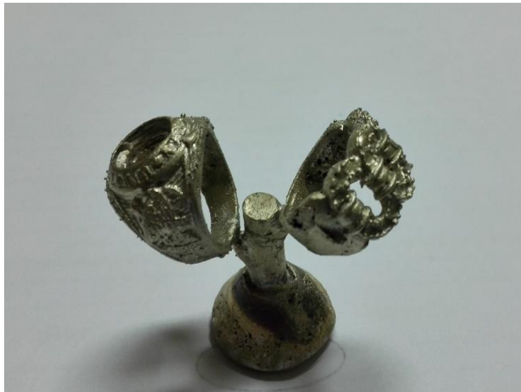
Figura 17. Anillos fundidos con Ag con vacío
