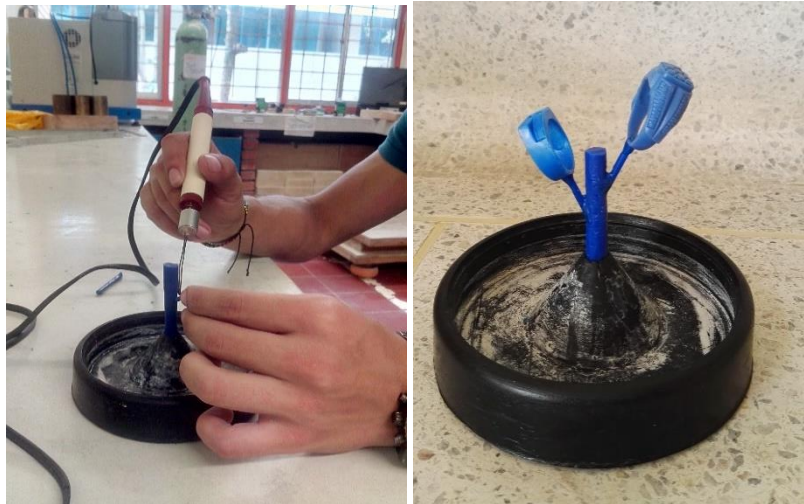
Figura 8. Preparación del árbol en cera en la base de goma
