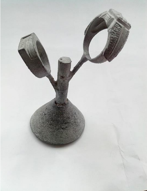
Figura 15. Anillos fundidos con la aleación Al4-Zn con vacío
