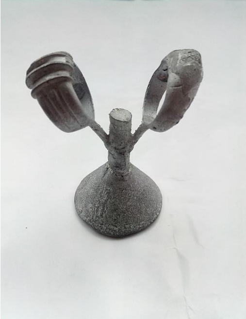
Figura 14. Anillos fundidos con la aleación Al4-Zn con vacío
