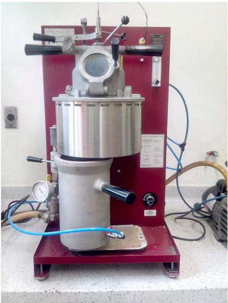
Figura 12. Horno para microfundición con colada al vacío marca NEUTEC USA modelo J2R
