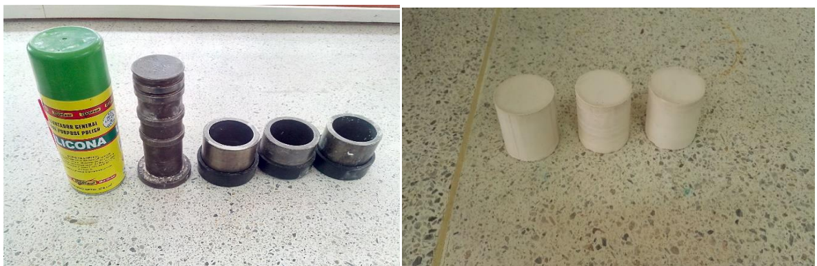
Figura 4. Cilindros en acero inoxidable con base de caucho vulcanizado, silicona para desmoldear y probetas fabricadas
