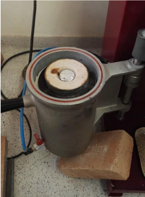
Figura 13. Proceso de inyección del metal en el interior del molde
