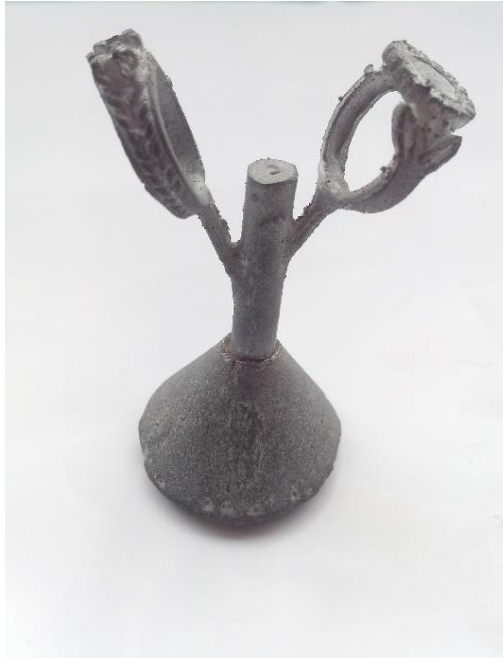
Figura 16. Anillos fundidos con la aleación Al14-Zn con vacío
