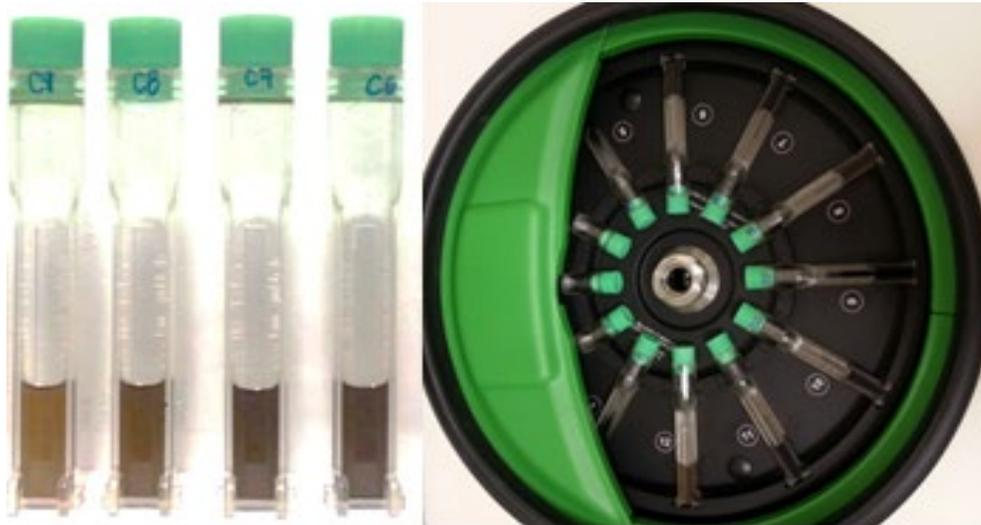
*Figura 4.3* Porta-muestra múltiple del analizador de dispersión LUMiSizer
