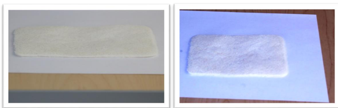
Figura 2. Aerogel biorgánico a base de nanocelulosa bacteriana.
