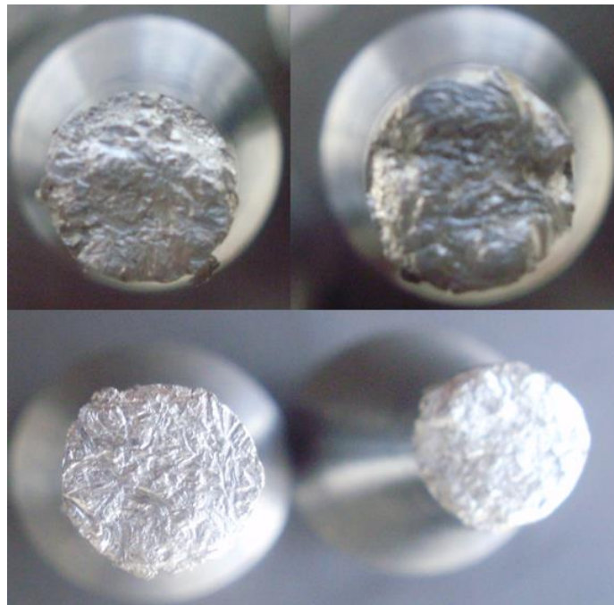
Figura 4.5.1 Fracturas en probetas 1020
