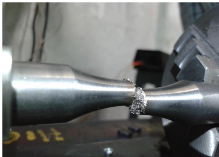
Figura 4.4.3 Fallo de la probeta
