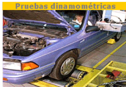
Figura 4-36: Pruebas dinamométricas para determinar las TBE
