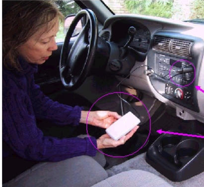
Figura 4-19: Dispositivo VOCE usado en la determinación de la distribución de los tiempos que demoran los vehículos apagados
