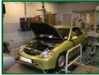
Figura 2-2: Prueba de chasis dinamométrico en Estados Unidos (FTP)
