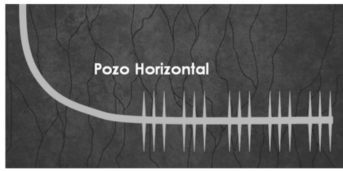
Figura 3 Los Pozos Horizontales interceptan mayor número de fracturas
