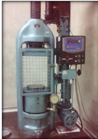
Figura 3. Prensa hidráulica para el ensayo de compresión.
