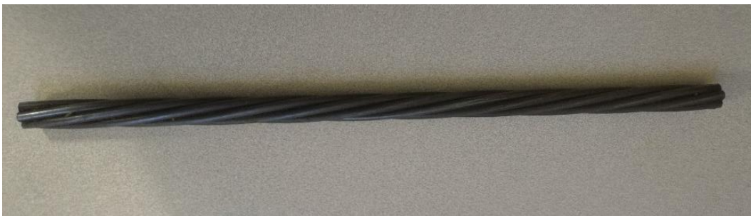
Figura 15. Tendón siete hilos denominación ASTM A416.
