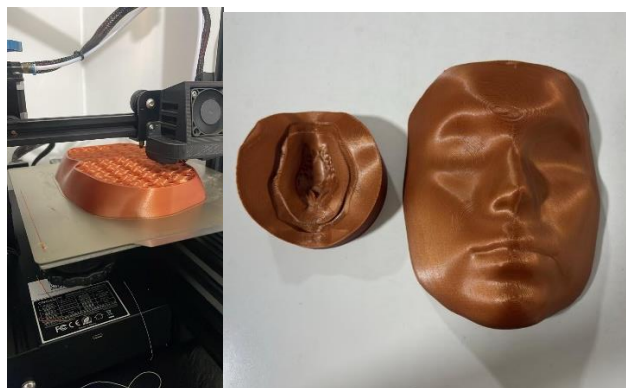
Impresión de molde nariz en impresora FDM
