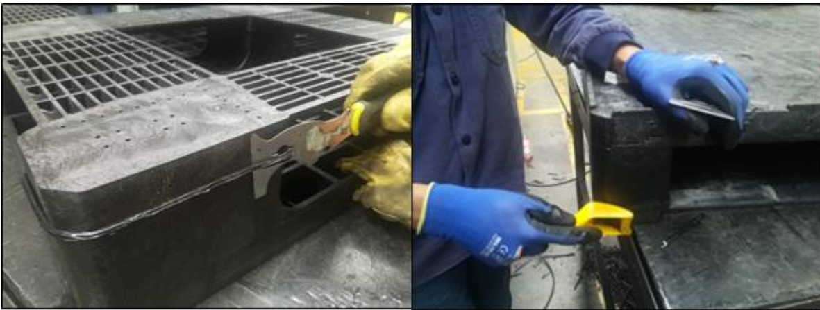
Figura 6. Acabado final del proceso de ensamble por termofusión
