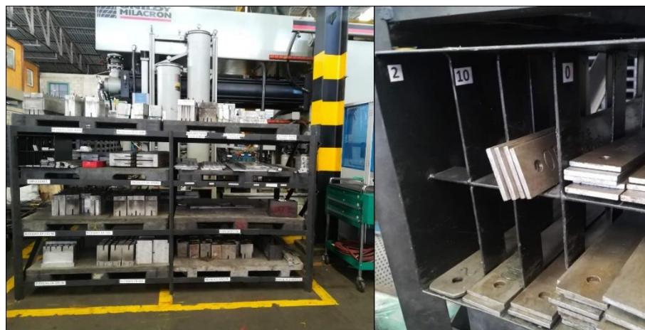
Figura 40. Almacenamiento bloques, expulsores y suplementos
