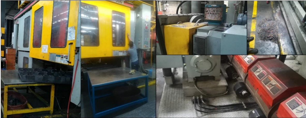
Figura 33. Limpieza máquina de inyección
