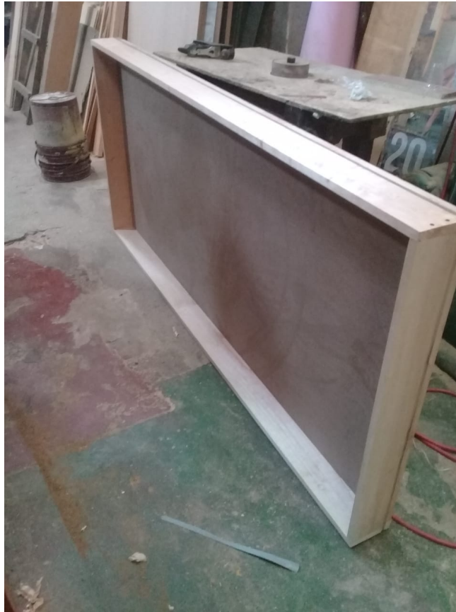
Figura 18. Construcción espejo, caja de madera
