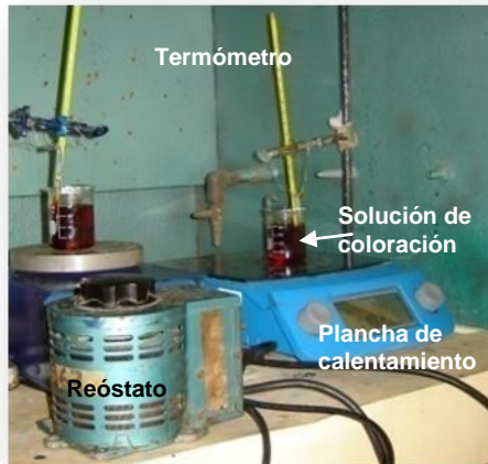
Figura 3 Montaje diseñado para la coloración del acero inoxidable mediante tratamiento químico
