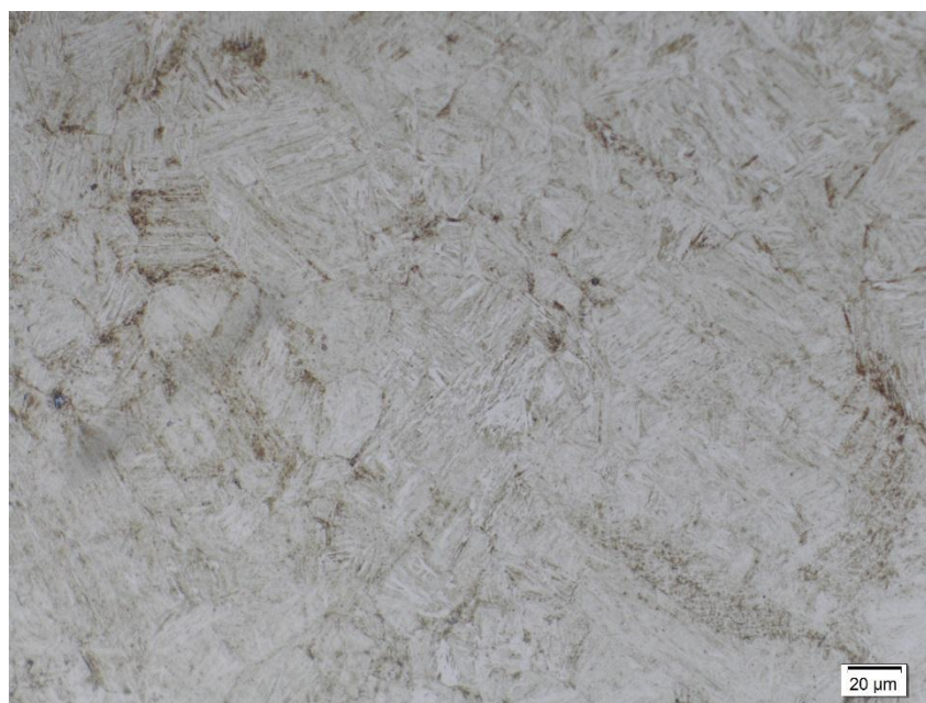
Figura 23. Muñón de biela Centro a 500X
