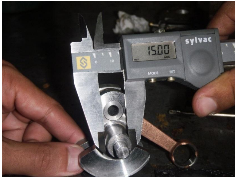
Figura 40. Medida del muñón de bancada
