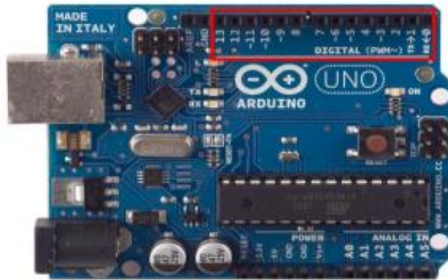
Figura 5. Entradas / salidas digitales Arduino UNO.
