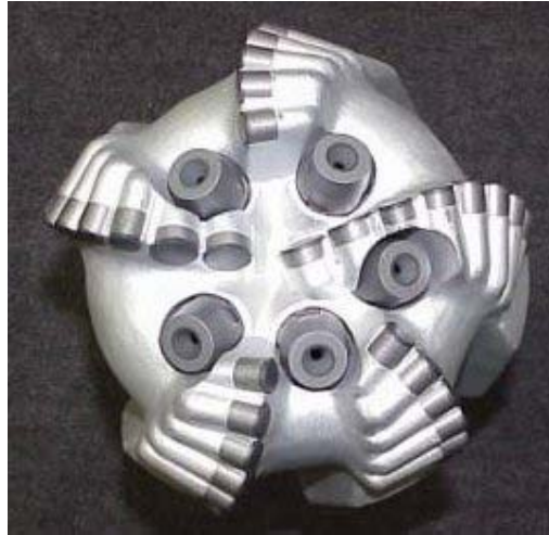
Figura 3. 1 Canales de Flujo de una Broca.
