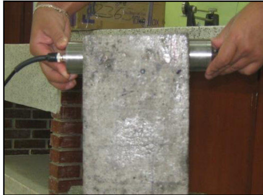
Fotografía 13. Método directo, ubicación de los palpadores.
