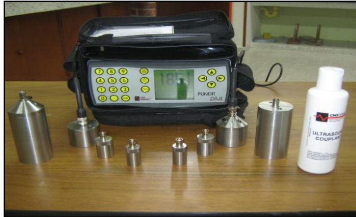
Fotografía 2. Equipo de ultrasonido de baja frecuencia CNS FARNELL Modelo Pundit Plus
