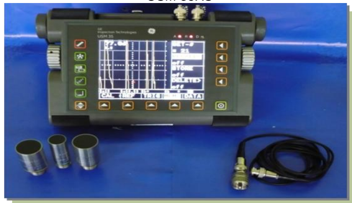
Fotografía 3. Equipo de ultrasonido de alta frecuencia KRAUTKRAMER USM 35XS
