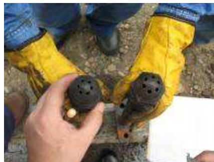
Figura 24. Diferencia de tamaños de los orificios de los quemadores usados para la combustión
