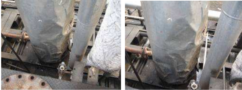
Figura 29. Deformación y pérdida del recubrimiento de la parte inferior del foil
