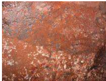
Figura 26. Superficie del piso del domo de vapor, presenta socavadura y picado
