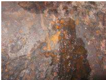
Figura 26. Superficie del piso del domo de vapor, presenta socavadura y picado
