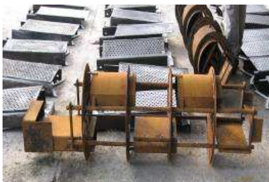
Figura 32. Estado de los internos de la despojadora D2
