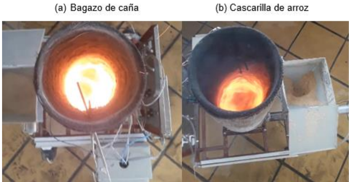
Figura 46. Prueba de combustión para bagazo de caña y cascarilla de arroz.
