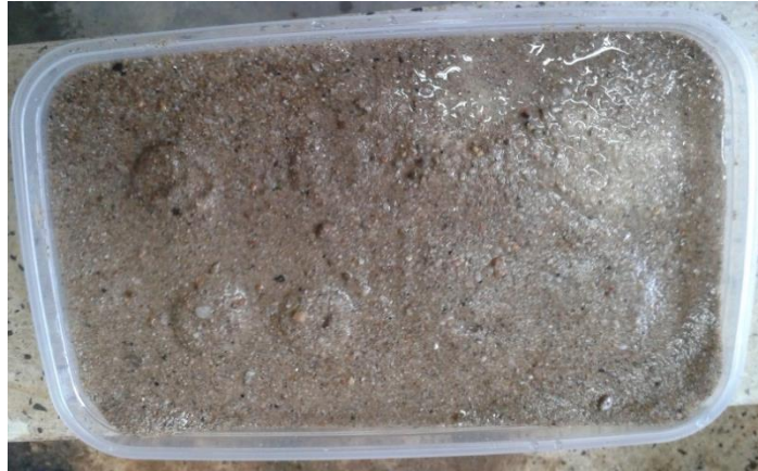
Figura 7. Curado de Probetas – Proceso de Inmersión.
