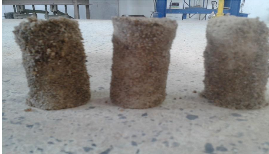
Figura 10. Probetas de suelo natural después de curado.
