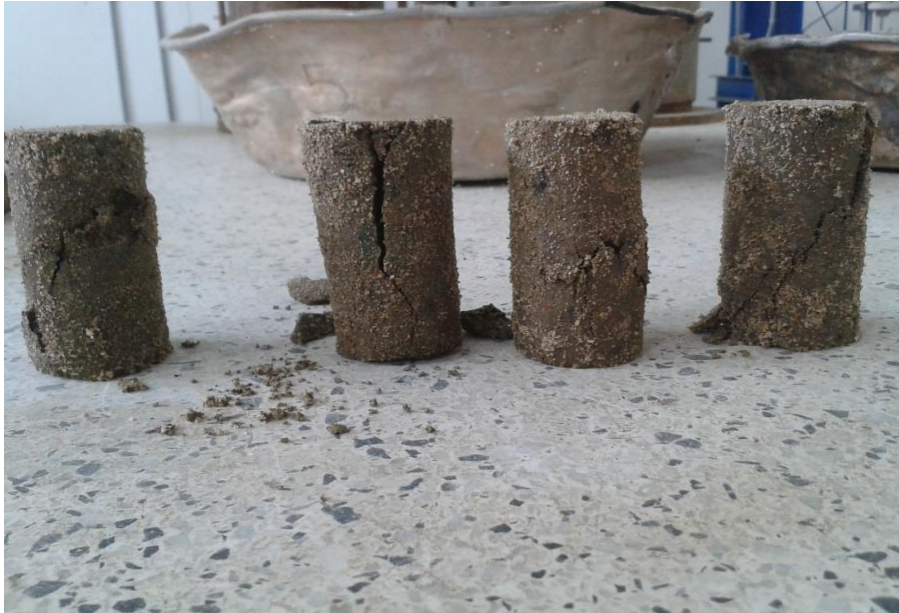
Figura 11. Probetas con aditivo luego de ser falladas.
