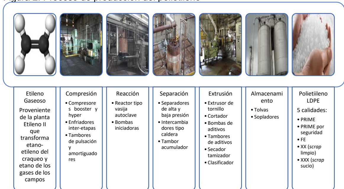
Figura 2. Proceso de producción del polietileno
