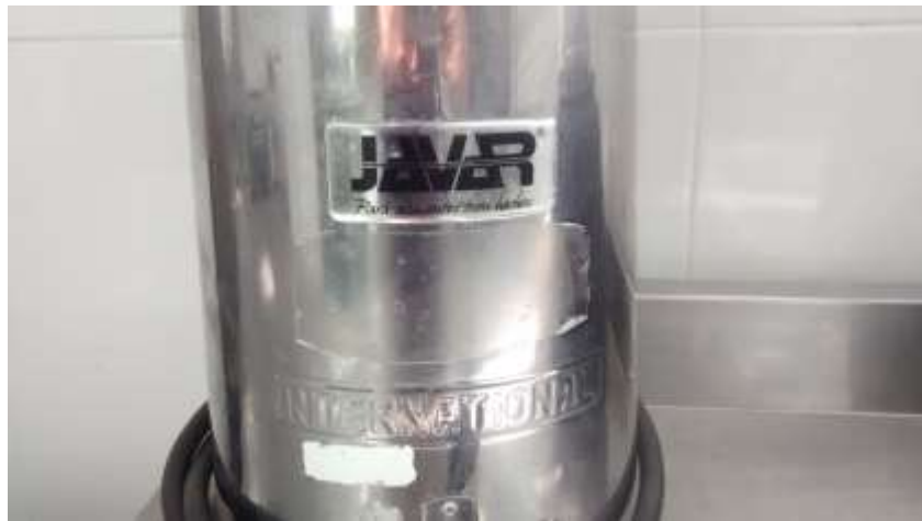
Figura 10. Ejemplo de deterioro marcación
