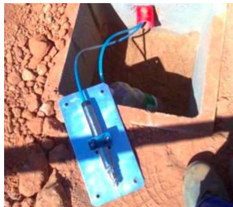
Figura 17. Celda de asentamiento.
