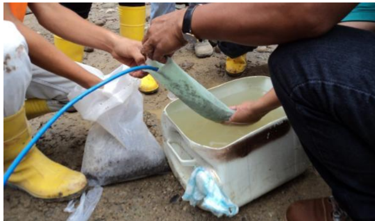
Introducción del piezómetro de hilo vibrátil en el saco geotextil.
