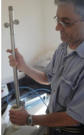
Torpedo ingresando en la tubería inclinométrica
