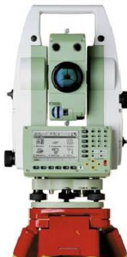
Aspecto Estación Total TPS1200
