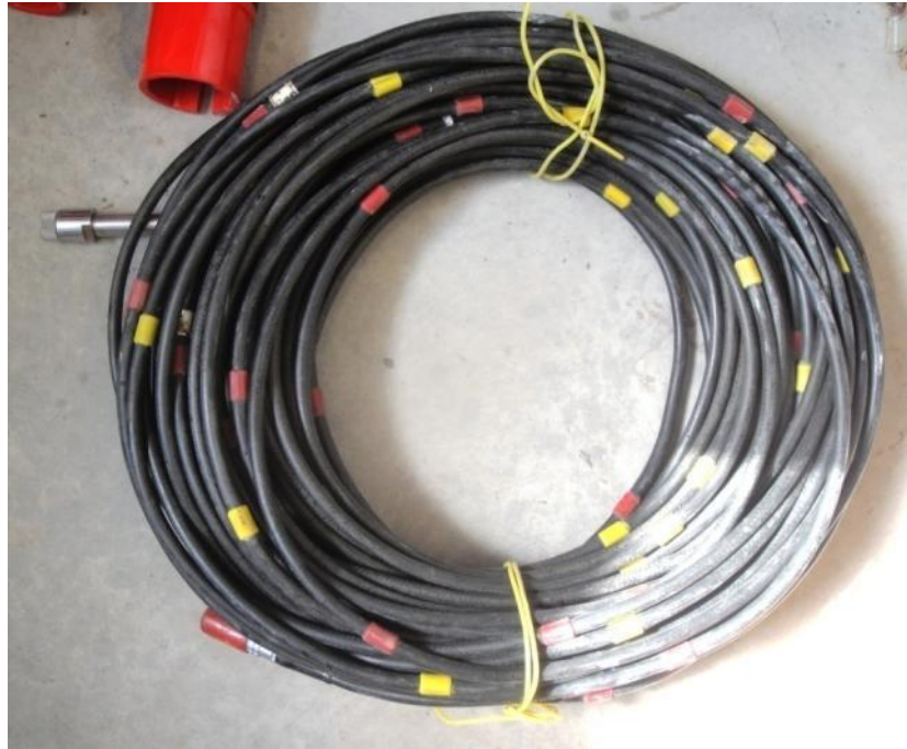
Cable de conexión entre en torpedo y el instrumento de lectura.
