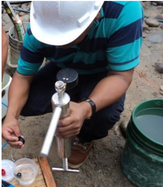
Acople del filtro cerámico al saturador.
