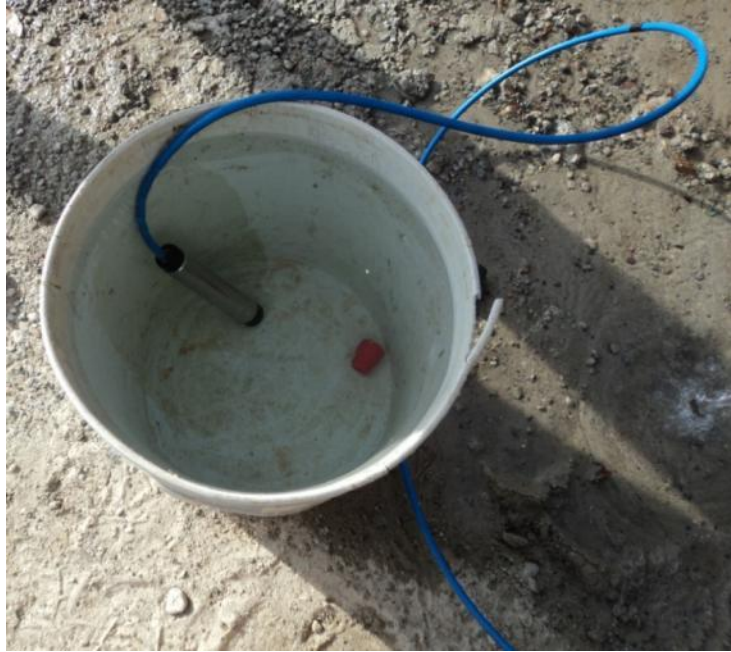
Roscado del filtro cerámico al piezómetro de hilo vibrátil bajo el agua.
