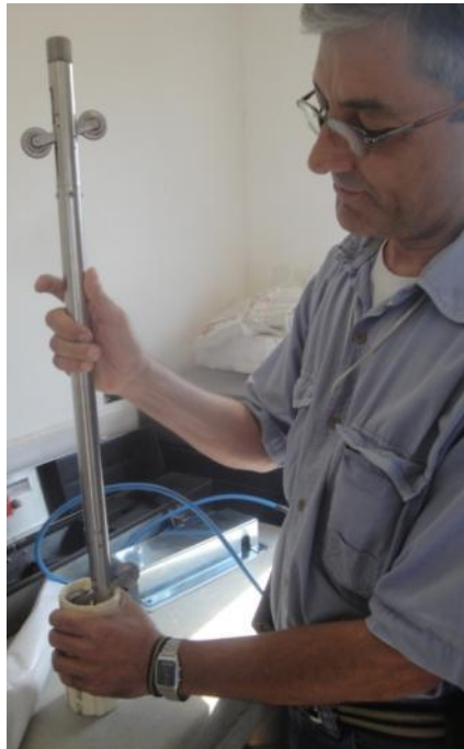
Figura 7. Torpedo ingresando en la tubería inclinométrica
