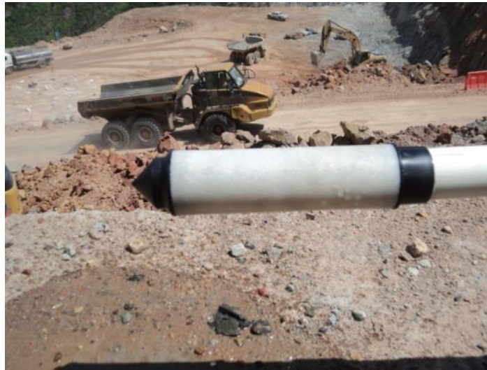
Punta de plástico poroso tipo Casagrande.
