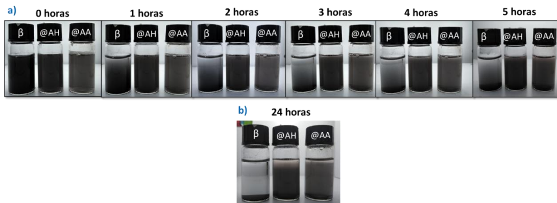
Figura 27. Imagen de suspensión acuosa 100 ppm después de 5 horas para \text{MnO}_2 ( \beta ), \text{MnO}_2 funcionalizado con ácido adípico ( \text{MnO}_2@AA ) y ácido hexanoico ( \text{MnO}_2@AH ). pH agua=5.8
