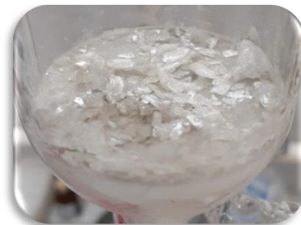
Figura 14. Cristales purificados de (E)-N-benciliden-4-fluoroanilina (3b) en n-heptano.
