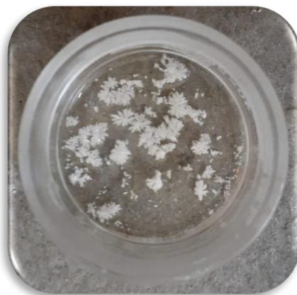
Figura 13. Cristales purificados de (E)-N-benciliden-4-cloroanilina (3a) en solución EtOH:H 2 O (4:1)
